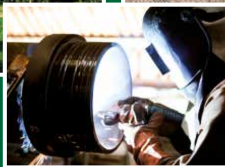
Verschweißen von Spitzende und Rohr
